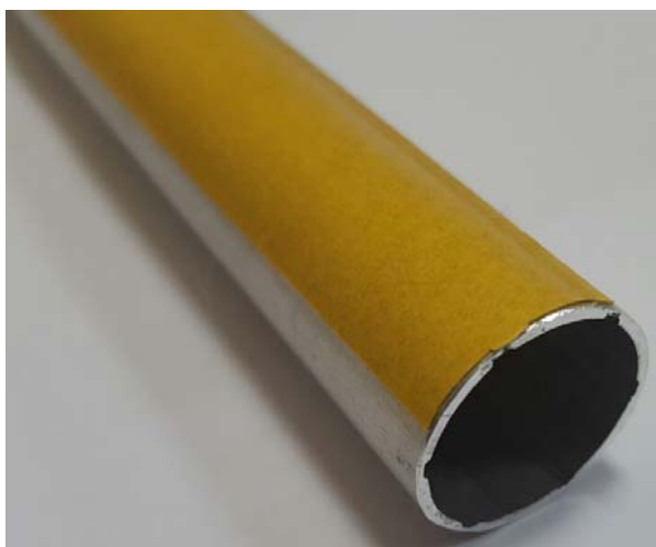
Рис. Наклеивание клейкой ленты на трубу
