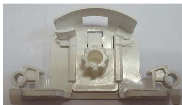
Рис. Установка вставки с шестерней MINI.
