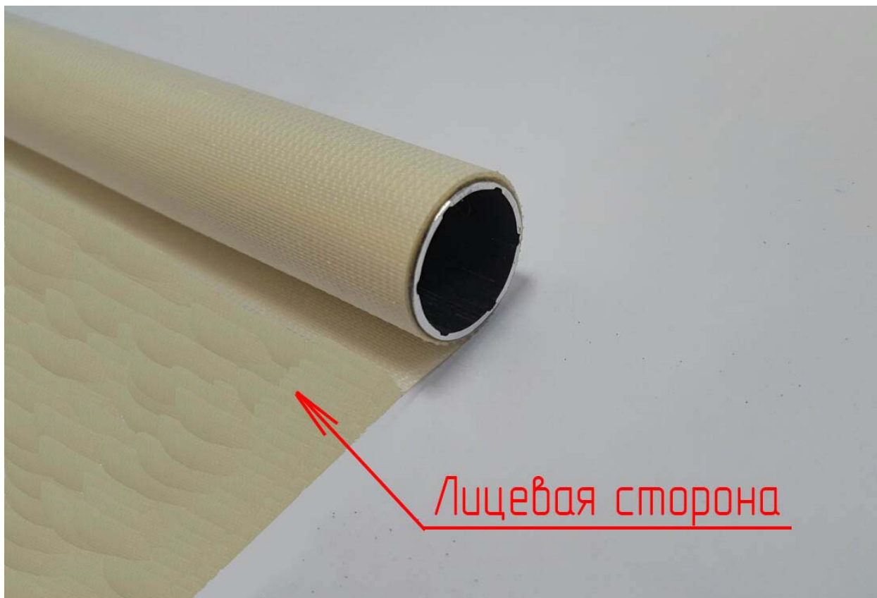
Рис. Приклеивание и намотка ткани на трубу (для случая, когда в графе «Сторона управления» указано «Правое»)
