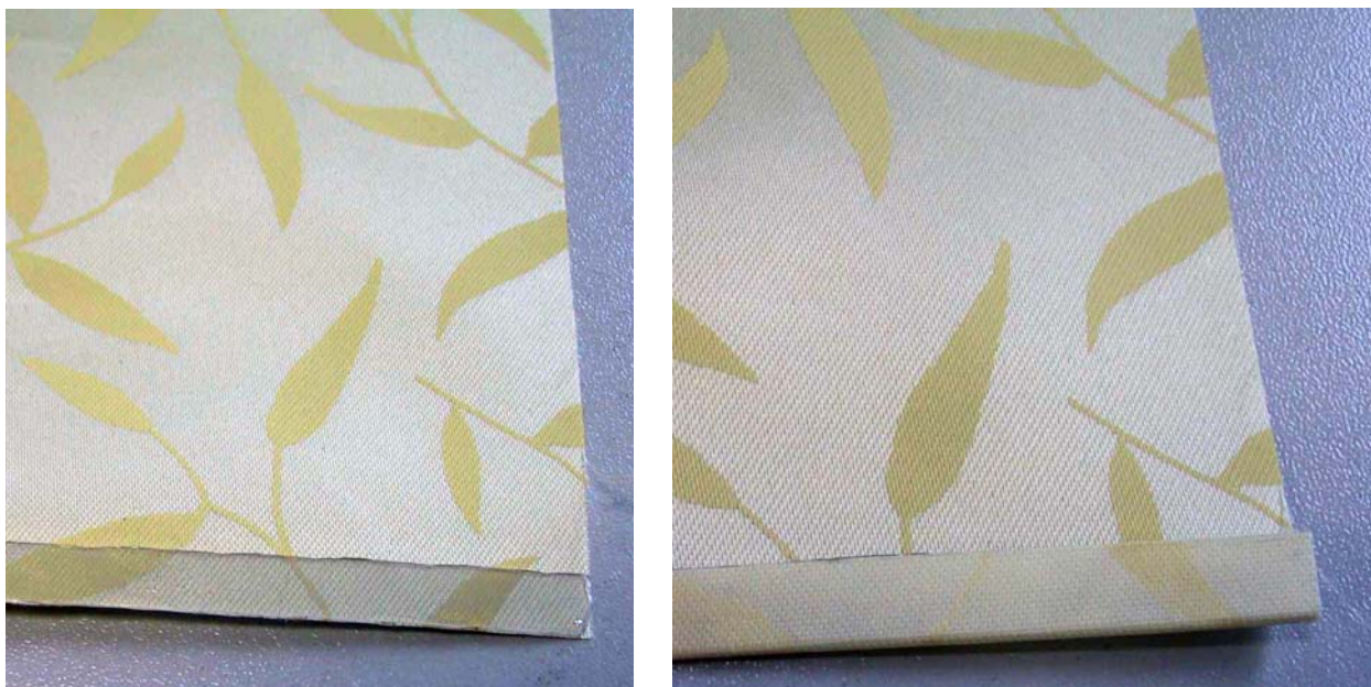
Рис. Наклеивание полосы-фиксатора и подгиб ткани
